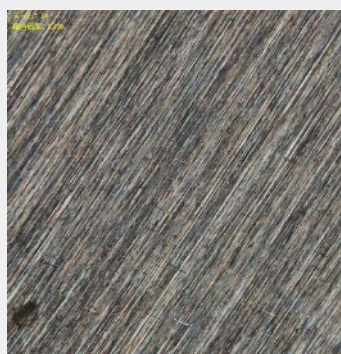
サビ Zero 使用による研磨面
