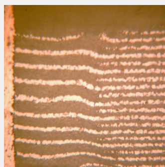
チップコンデンサ 斜め研磨
